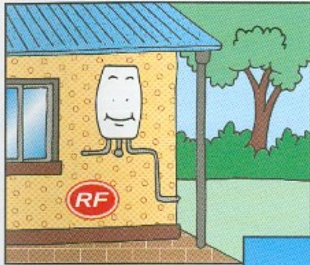
1. 瓦斯熱水器以裝設在屋外牆壁或開放陽臺為原則，為了安全起見，應採用屋外型RF式熱水器。
